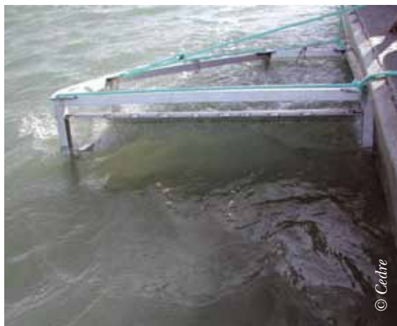
Matériel de récupération spécifique facilitant le confinement et la récupération manuelle du polluant
