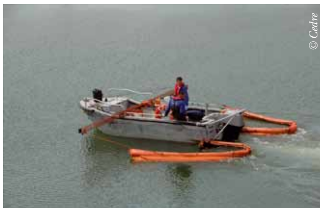
Récupération dynamique d'une pollution de faible ampleur à l'aide d'un barrage absorbant à jupe lestée et d'une embarcation légère
