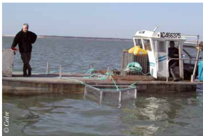
Mise en œuvre de paniers de récupération à partir d'une barge ostréicole, lors de la pollution du Prestige, 2002
