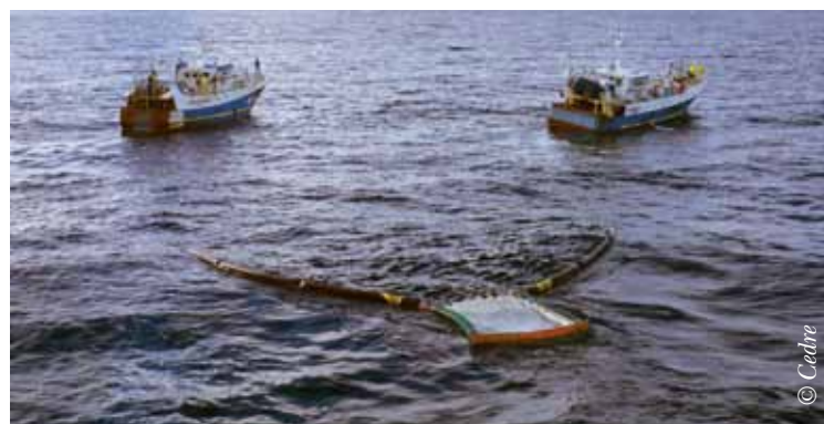
Récupération dynamique d'hydrocarbures avec un chalut spécifique antipollution
